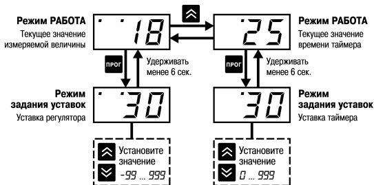
Рисунок 7.1 – Схема задания уставок регулятора и таймера
